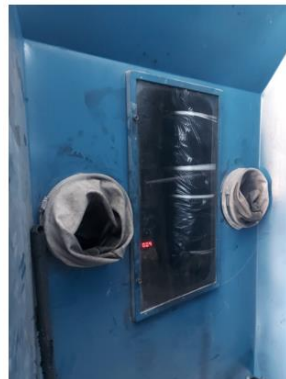
Cabine de pesagem (parte externa)
